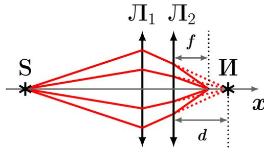
Рис. 5: Система из двух линз.  $S$  — лампочка;  $\mathcal{L}_1$  — первая линза;  $I$  — изображение лампочки в первой линзе, расположенное в точке  $x_1 = 70$  см;  $\mathcal{L}_2$  — вторая линза с фокусным расстоянием  $F = 60$  см, расположенная в точке  $x_2 = 40$  см.
