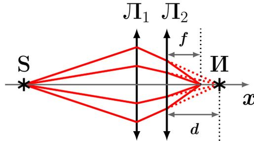
Рис. 10: Система из двух линз.  $S$  — лампочка;  $\mathcal{L}_1$  — первая линза;  $I$  — изображение лампочки в первой линзе, расположенное в точке  $x_1 = 80$  см;  $\mathcal{L}_2$  — вторая линза с фокусным расстоянием  $F = 30$  см, расположенная в точке  $x_2 = 60$  см.
